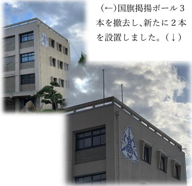
【2】(←)1棟の屋上にある国旗・校旗掲揚ポール3本は、長年の風雨により根元が腐食し倒壊・落下の危険がありましたので、12月に撤去しました。1本減じて、新たに2本のポールを1月上旬に設置しました。1棟屋上の新しい姿をご覧ください。
